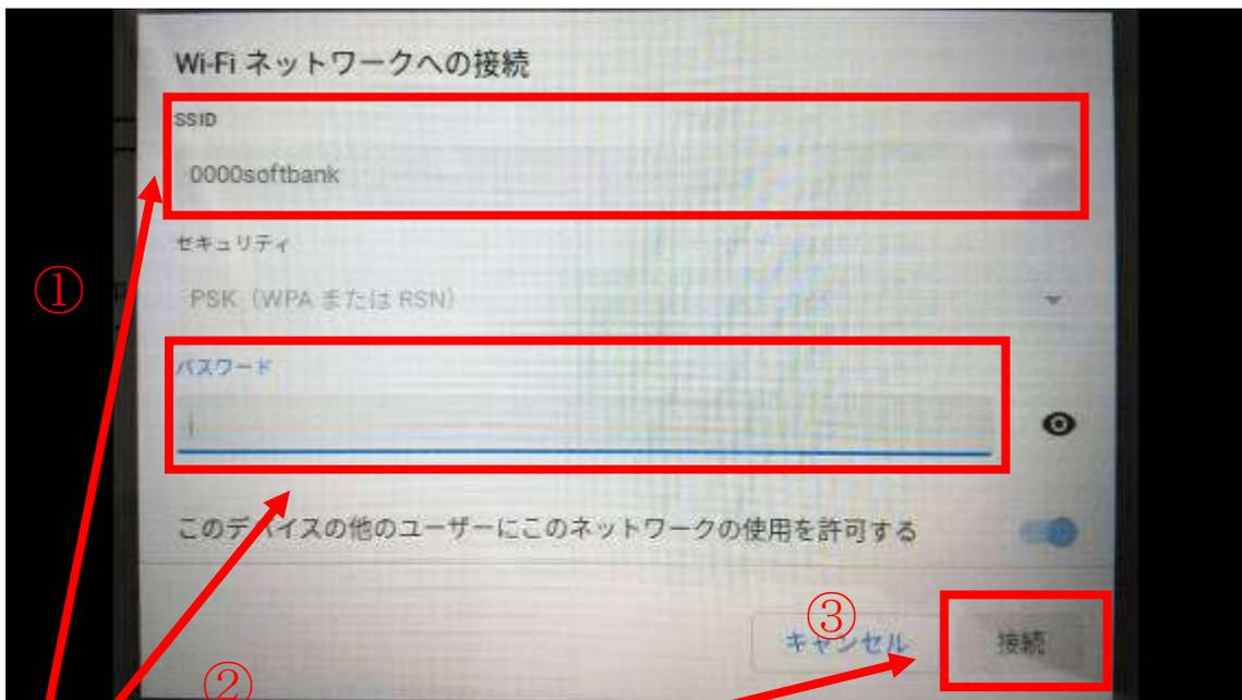
SSIDとパスワードを入力し、接続をタップします。
